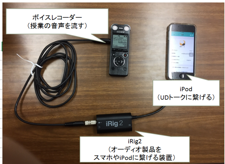
図3 「ボイスレコーダーからUDトークに認識させている」(写真)
